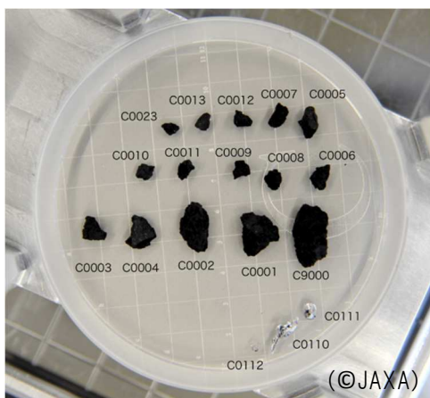
図1 回収した大型の粒子(10mm超～3mm) 右下は採集時に発生した金属片(アルミ) レプリカに対応するのは下段中央
